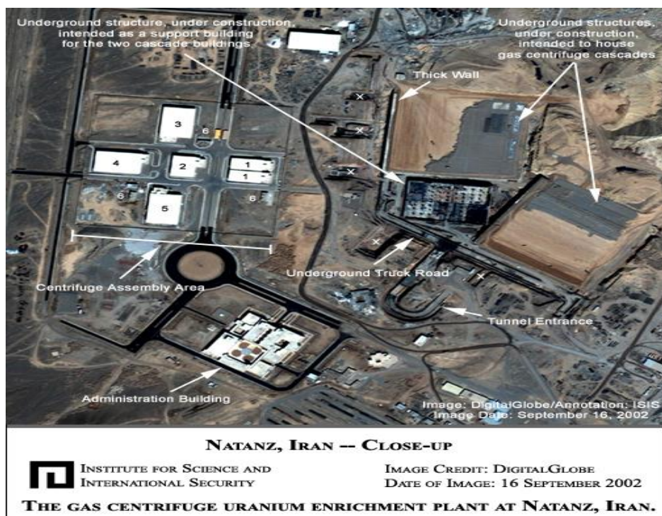
Fig. 12. Uzina iraniană de îmbogățire a uraniului cu centrifugă cu gaz de la Natanz. Sursa: https://isis-online.org/publications/iran/natanz03_02.html .
